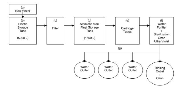
Figure 1. Scheme of refilled drinking water treatment process. (Source : Ananto K (2002) Peranan ASPADA Dalam Pembinaan Depot Air Minum. Pertemuan Pengelola Program Makanan dan Minuman Industri Rumah Kabupaten/Kota Se Jawa Tmur di Dinas Kesehatan Propinsi Jawa Timur.)
