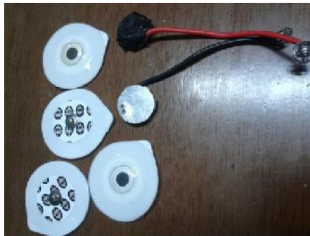
Gambar 2. Elektrode EKG dan Elektrode Penelitian
